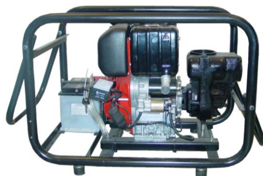
BWS MAM6 in kooiframe met accu en startpaneel
